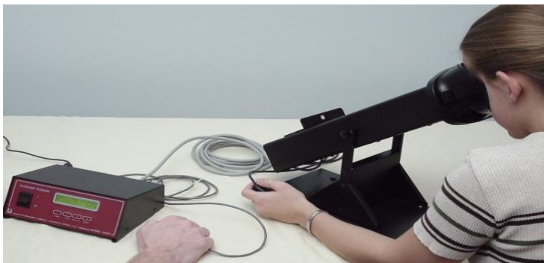
Figura 3 - Aparelho para registrar a frequência crítica de cintilação-fusão (FCF)
