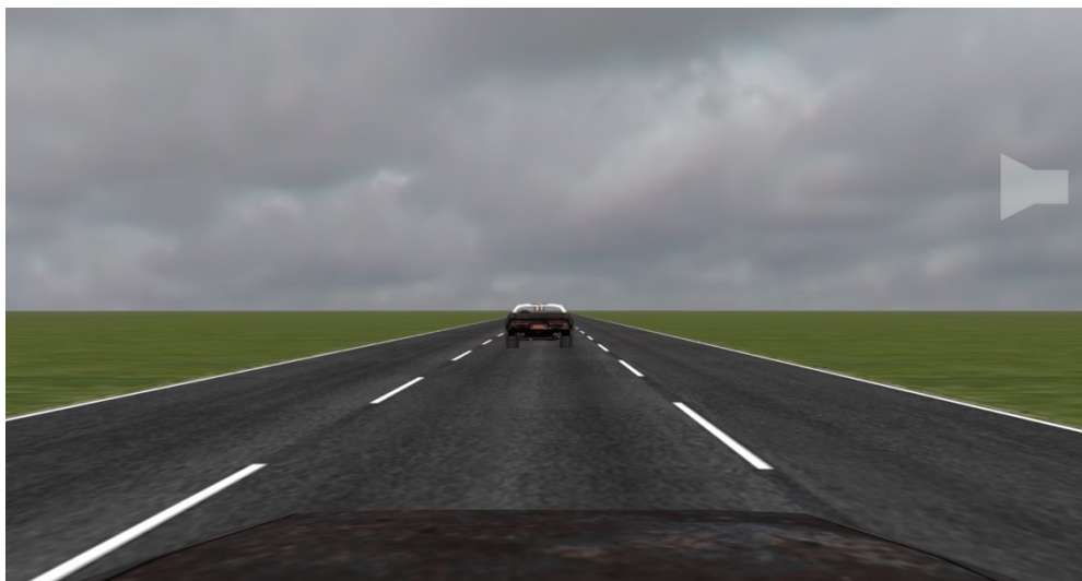
Figura 3 – Imagem da tela do simulador veicular durante o teste de atenção dividida e a tarefa central de seguir um automóvel no momento de aparecimento do estímulo superiormente à direita. Ao ver esse estímulo, o participante deveria pressionar um botão no volante do simulador.
